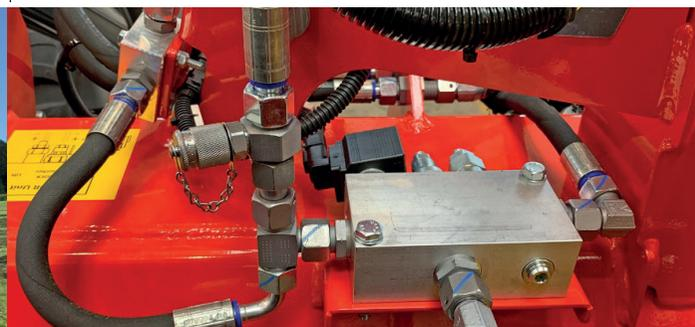
Module rotor : La suspension et l'amortissement du rotor peuvent être ajustés.
