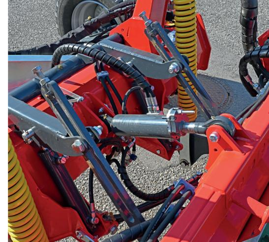
Réglage de la hauteur de ramassage par la liaison supérieure. La hauteur de base de l'andaineur est réglée par des plaques d'écartement. En appuyant sur un bouton dans le terminal, il est possible de travailler plus bas en bout de champ, par exemple.
