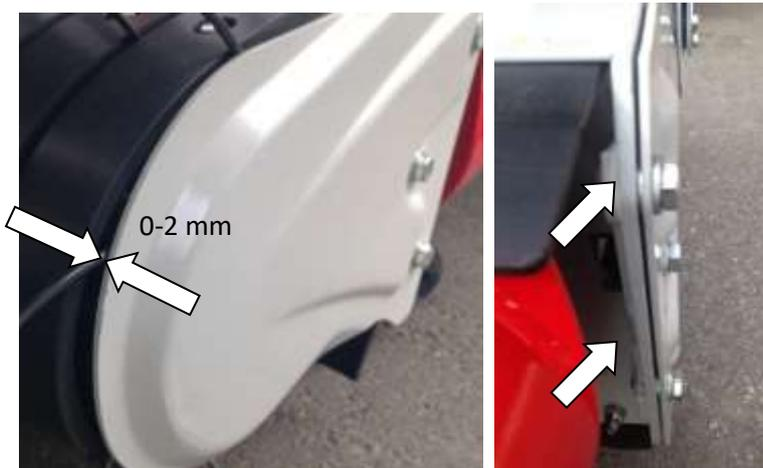
Le réglage s'effectue au niveau de la tôle encart ou des rondelles à l'aide des deux vis arrières.
