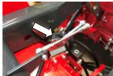
capteur d'angle relevage
