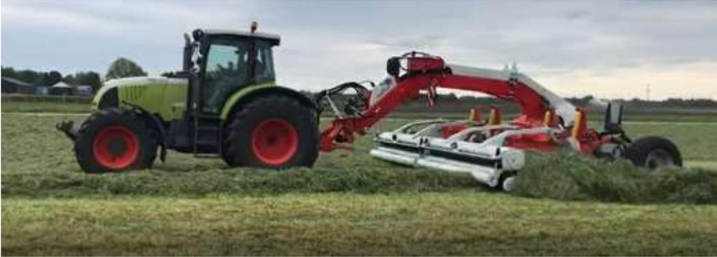
18. Pour le fonctionnement sur une pente, un lestage frontal est utile.
