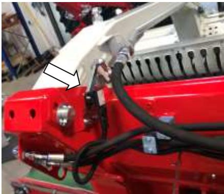
capteur d'angle rotor
