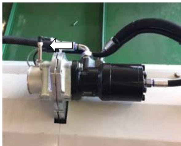
Capteur de vitesse de rotation du rotor
