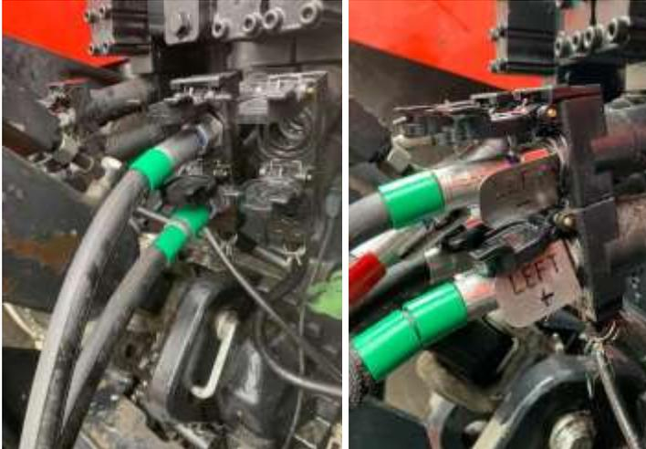
3. Connectez la connexion à double effet 2 à l'unité de contrôle 2. Faites attention à la connexion correcte de la pression (RIGHT + / deux clips) et du côté retour (RIGHT - / un clip).
