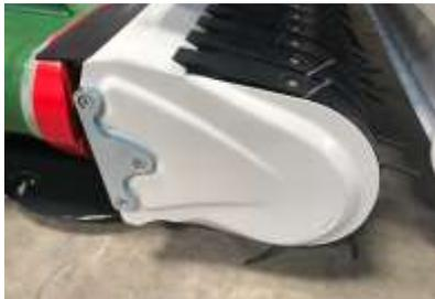
Plaque de renfort du couvercle du pick-up à l'intérieur protège les vis et le couvercle pour le cas de contacts des pick-up's.
