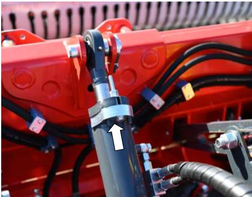
Réglage du hauteur de travail: sur un sol plat, la distance entre le pick-up et le sol doit être environ 1cm – 1,5cm.
