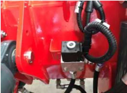
Soupape électromagnétique pour bloquer des
