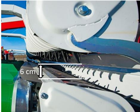
Höheneinstellung des Rotors (Abstand Rotor zu Pick-up)
