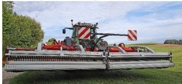
Bei laufenden Arbeitseinheiten kann zu wenig Öl für das Hubwerk zur Verfügung stehen, das Hubwerk hebt nicht hoch.
