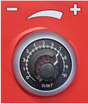
Bandgeschwindigkeit wird über das Drehpotentiometer von Null bis Maximum eingestellt.
