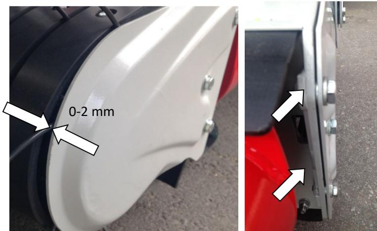
Einstellung über Beilageblech oder Beilagscheiben an den beiden hinteren Schrauben.
