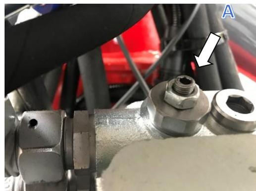
Utilisation de Load Sensing: vis sans fin avec la largeur du clé Allen 4, tournez à fond dans le sens des aiguilles d'une montre et bloquer avec contre-écrou.
