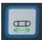
En appuyant sur ce bouton pendant environ 2 secondes, le signal sonore retentit, la direction des deux tapis va changer extérieurement.
