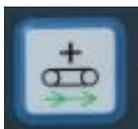
Une courte pression sur ce bouton augmente la vitesse des deux convoyeurs. Pour une forte augmentation de la vitesse du tapis, répétez l'opération plusieurs fois.
