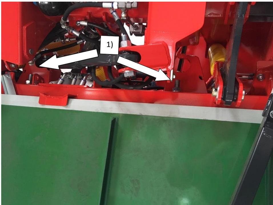
1.1 Desserrer la fixation centrale du pick-up par le biais du contre-écrou (1) au niveau des tiges filetées
