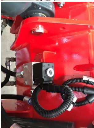
Soupape électromagnétique pour bloquer des cylindres transversal
