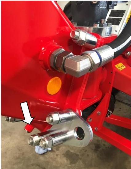
(A) Maintenance d'huile: Videz l'eau et la saleté une fois par an à l'aide d'écrou de vidange. Une petite quantité suffit pour cela. Puis refermez soigneusement la vis.
