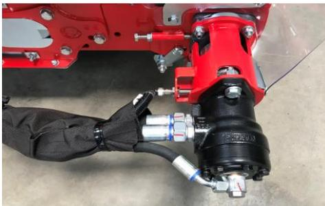
Entraînement du tapis avec le moteur hydraulique et l'accouplement
