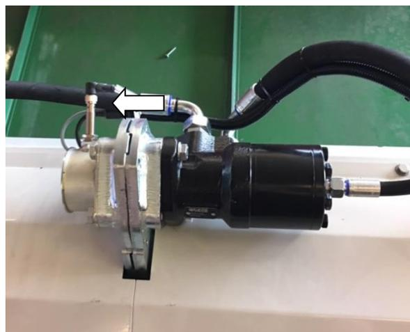
Capteur de vitesse de rotation du rotor
