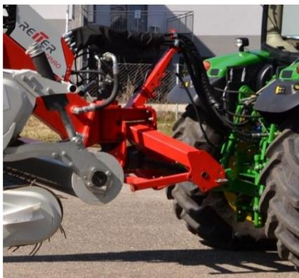
2. Donnez pression a la connexion double effet 1 et 2 jusqu'à ce que les deux unités de travail soient complètement serrées vers la structure du châssis télescopique
