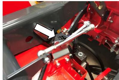
capteur d'angle relevage
