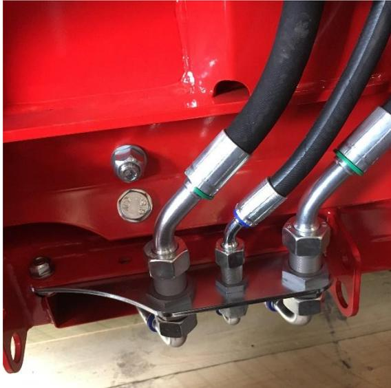
1.2 Séparez les conduites hydrauliques de l'entraînement du pick-up. Évitez que l'huile hydraulique ne s'échappe en utilisant des bouchons d'étanchéité.
