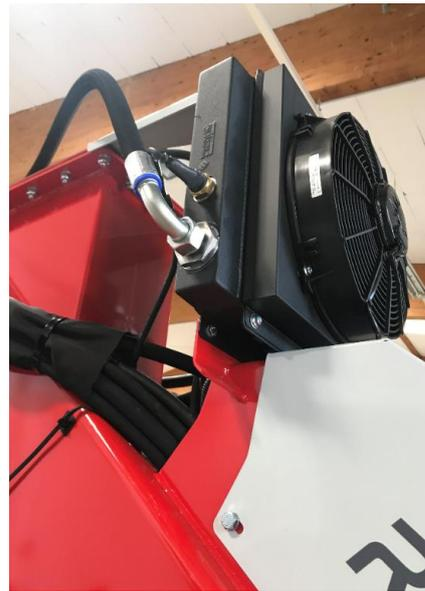
refroidisseur d'huile avec le capteur de température et retour de l'huile dans le filtre de retour
