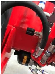
Vanne de régulation de débit ajustable est réglé en usine.
