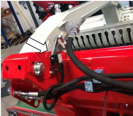
capteur d'angle rotor
