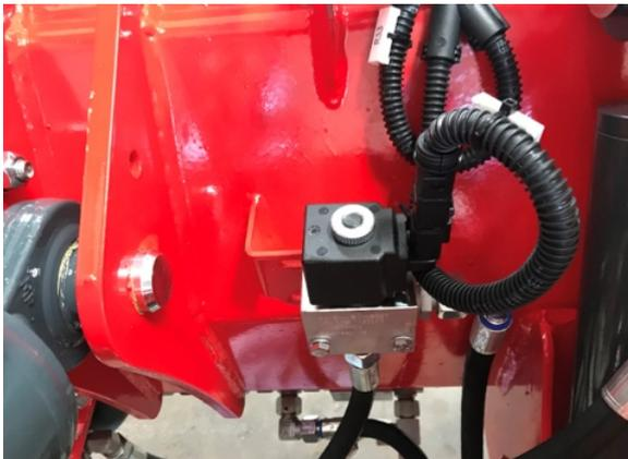
Elektromagnetisches Ventil zum Sperren der
