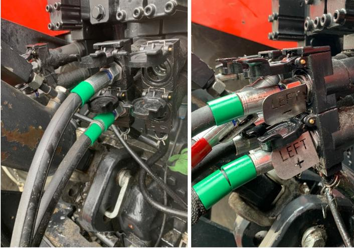
3. Doppeltwirkender Anschluss RECHTS mit Steuergerät 2 verbinden. Auf den richtigen Anschluss von Druck- (RIGHT + / zwei Clips) und Rücklaufseite (RIGHT - / ein Clip) achten.
