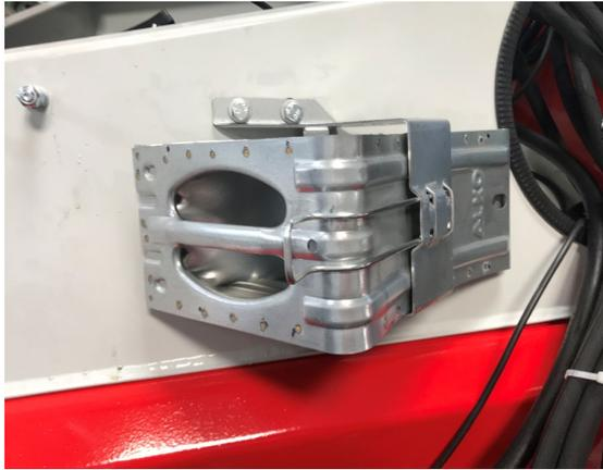
Unterlegkeil für das sichere Abstellen der Maschine
