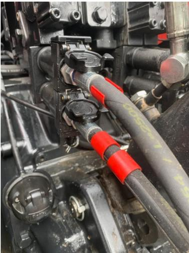
4. Die Load-Sensing-Schläuche mit den Anschlüssen des Traktors verbinden
