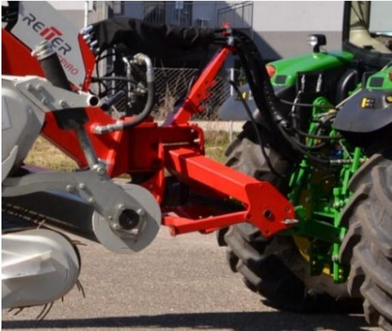
2. Steuergeräte 1 und 2 auf Druck geben bis beide Arbeitseinheiten zum Teleskoprahmen hin ganz angezogen sind.
