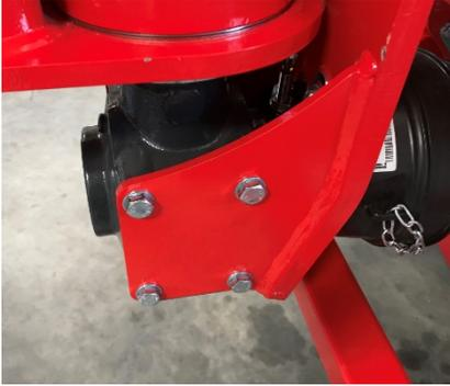
5. Hydraulischen Antrieb auf Dichtheit prüfen
