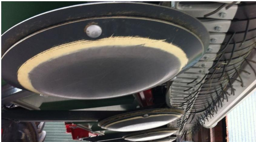
Die Abnutzung der Verschleißsteller ist täglich zu überprüfen. Sobald ein Verschleißsteller durchgeschliffen ist, ist der Wechsel vorzunehmen. Auf diese Weise wird die Beschädigung des Grundtellers vermieden.
