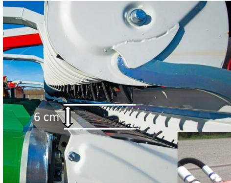
Höheneinstellung des Rotors (Abstand Rotor zu Pick-up)
