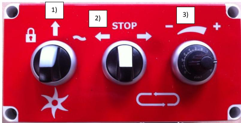
Bedienterminal für Rotor und Band
