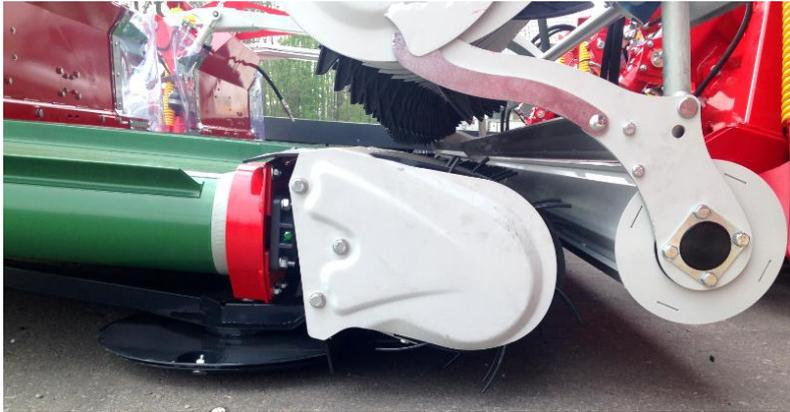
Richtige Länge des Oberlenkers wählen, um die gewünschte Arbeitshöhe der Pick-up Zinken zum Boden zu erreichen. Auf ebenem Untergrund soll der Abstand der Zinken zum Boden ca. 1-2 cm betragen.
