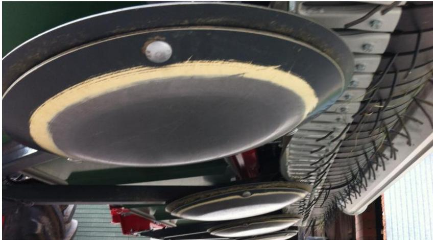
Die Abnutzung der Verschleißteller ist täglich zu überprüfen. Sobald ein Verschleißteller durchgeschliffen ist, ist der Wechsel vorzunehmen. Auf diese Weise wird die Beschädigung des Grundtellers vermieden.
