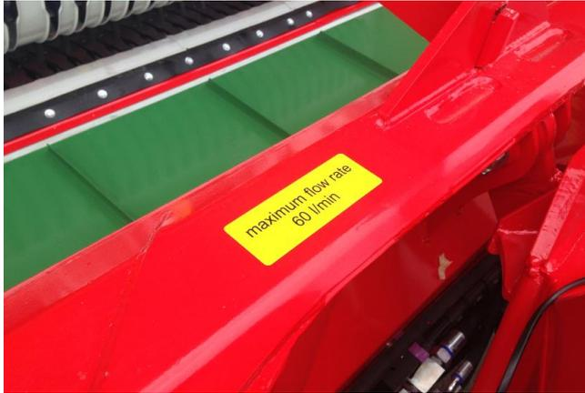
Maximaler Ölfluss 60 l/min
