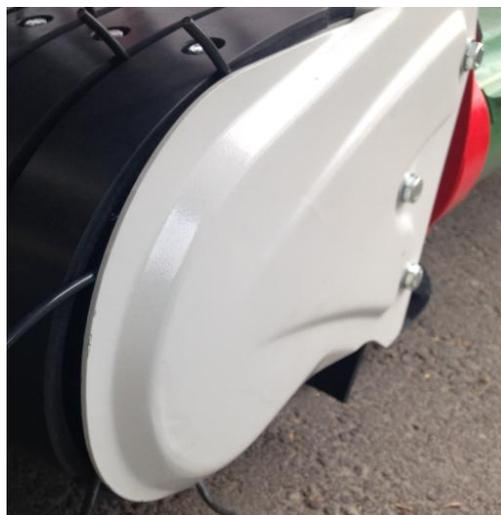
Einstellung über Beilageblech oder Beilagscheiben an den beiden hinteren Schrauben.
