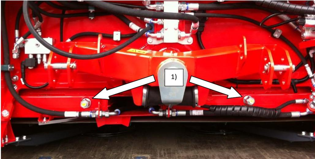
1.1 Die zentrale Fixierung der Pick-up über die Kontermuttern (1) an den Gewindestangen lösen
