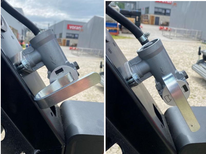
Handverstellbarer Bremskraftregler Volllast bzw. Halblast
