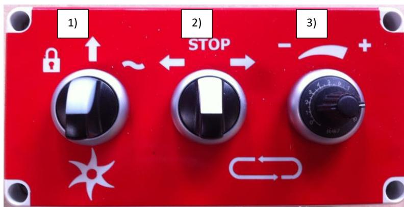
Terminal de commande pour le rotor et le tapis
