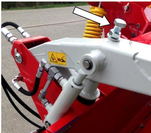
Réglage de la hauteur du rotor (distance entre le rotor et le pick-up)
