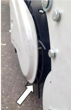
La distance entre le couvercle latéral et le premier racleur doit être d'environ 7-8 mm. La distance avec les dents du pick-up est donc seulement d'environ 0-2 mm.
