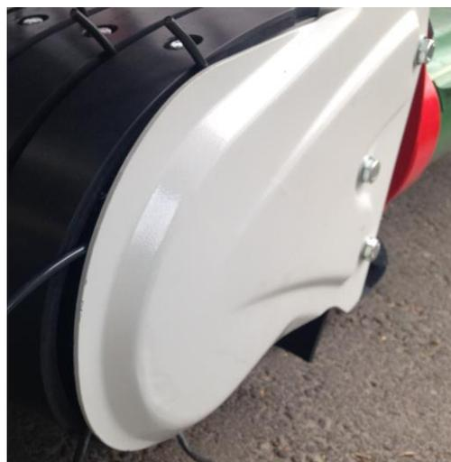
Le réglage s'effectue au niveau de la tôle encart ou des rondelles à l'aide des deux vis arrières.
