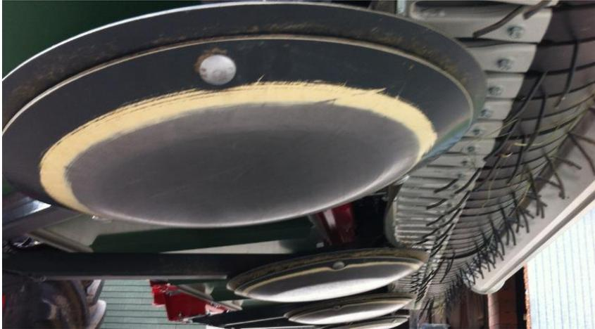
Contrôler quotidiennement l'usure des disques d'usure. Dès qu'un disque d'usure est perforé, il faut le remplacer. Cela permet d'éviter que les disques de base ne s'abîment.
