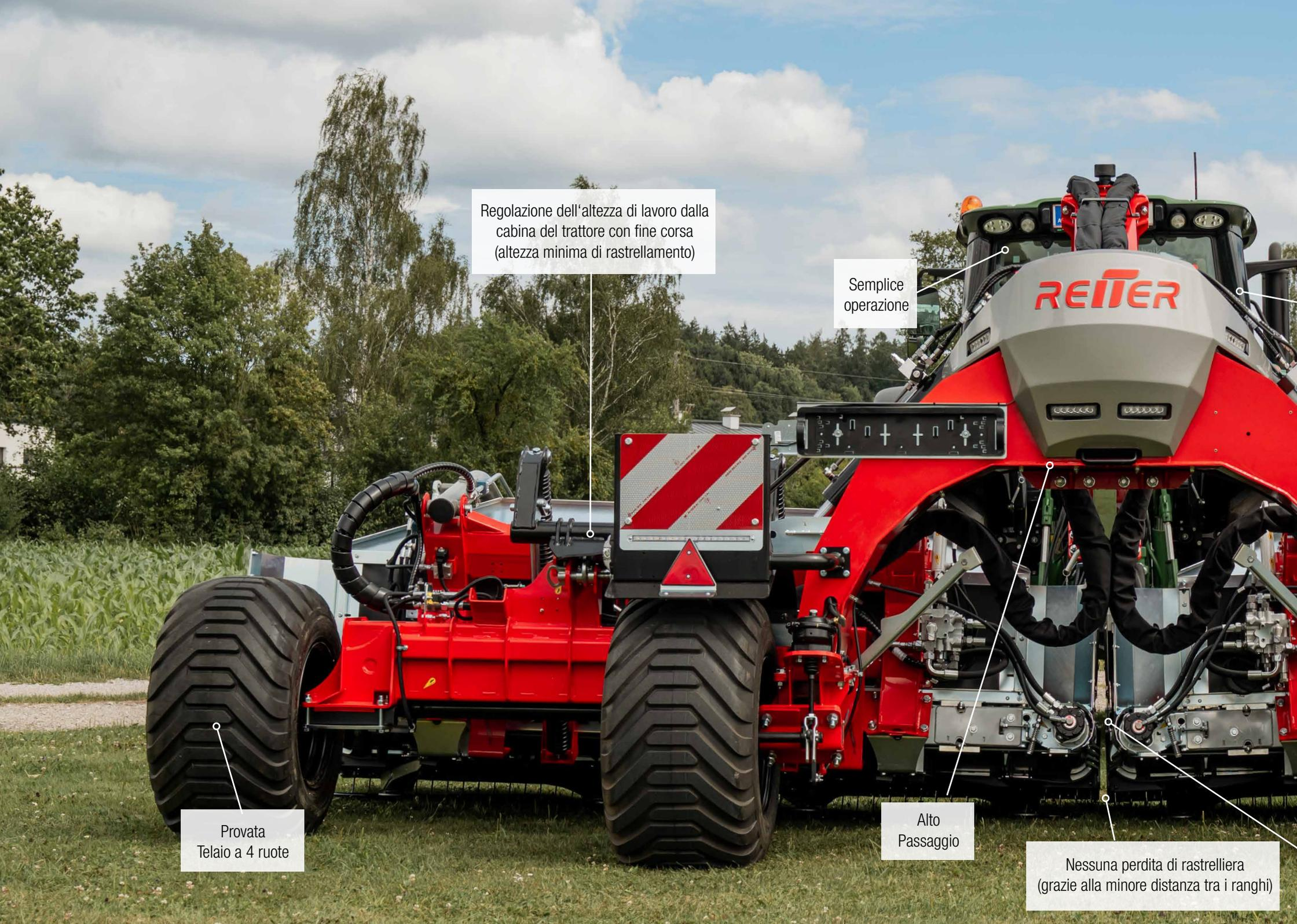
Regolazione dell'altezza di lavoro dalla cabina del trattore con fine corsa (altezza minima di rastrellamento)
