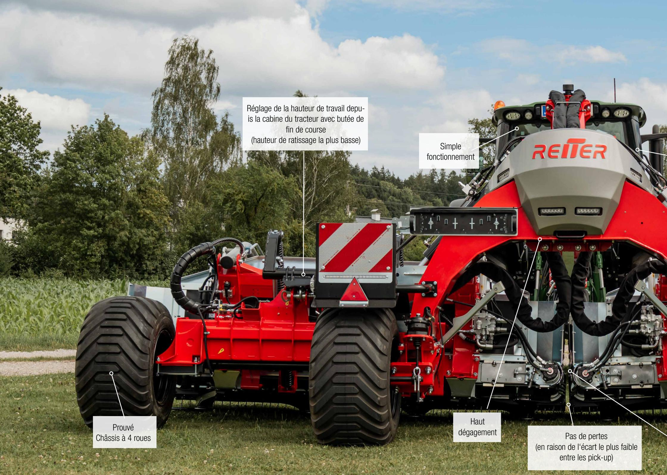
Réglage de la hauteur de travail depuis la cabine du tracteur avec butée de fin de course (hauteur de ratissage la plus basse)
