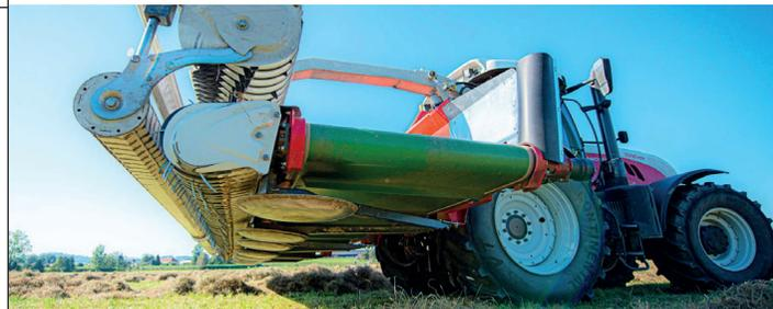
Par l'intermédiaire des bras, les forces sont transmises à l'arrière du pick-up.
