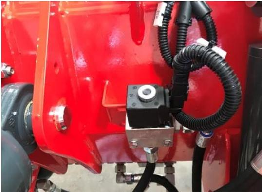
Soupape électromagnétique pour bloquer des
