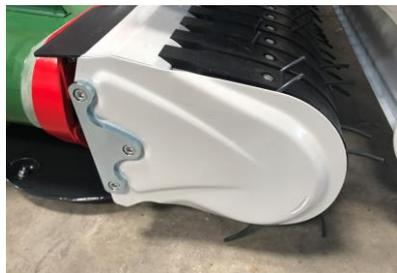
Plaque de renfort du couvercle du pick-up à l'intérieur protège les vis et le couvercle pour le cas de contacts des pick-up's.
