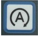
En appuyant sur ce bouton et en le maintenant enfoncé, les deux vérins des troisièmes points hydrauliques sont complètement rétractés.
