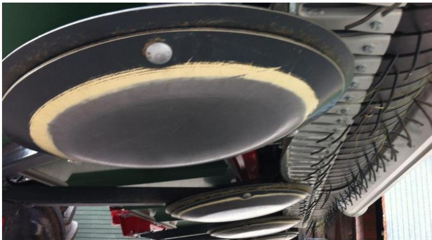
Contrôlez quotidiennement l'usure des disques d'usure. Dès qu'un disque d'usure est perforé, il faut le remplacer. Cela permet d'éviter que les disques de base ne s'abîment.
