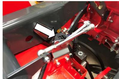
capteur d'angle relevage
