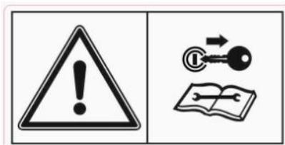
Éteindre le moteur et retirer la clé avant tous travaux d'entretien ou de réparation.
