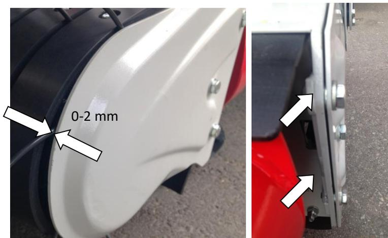
Le réglage s'effectue au niveau de la tôle encart ou des rondelles à l'aide des deux vis arrière.
