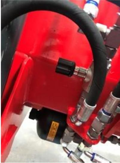
La vanne de régulation de débit ajustable est réglé en usine.
