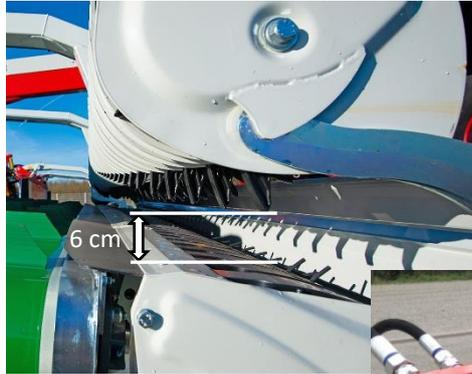
Réglage de la hauteur du rotor (distance entre le rotor et le pick-up)
