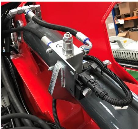
soupape pour frein de descente: ne pas changer le réglage
