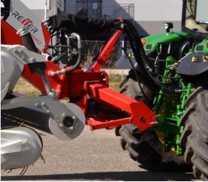
2. Donnez pression a la connexion double effet 1 et 2 jusqu'à ce que les deux unités de travail soient complètement serrées vers la structure du châssis télescopique
