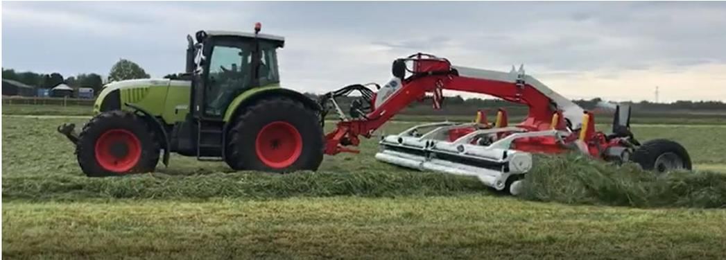
18. Pour le fonctionnement sur une pente, un lestage frontal est utile.
