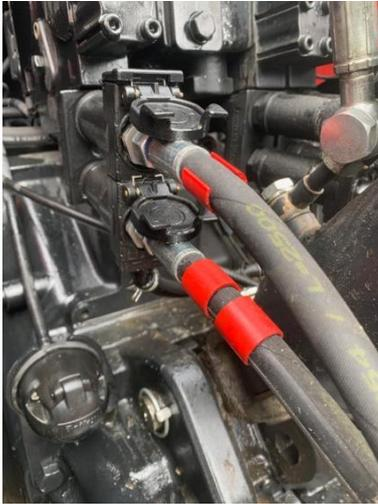
4. Connectez les tuyaux Load Sensing aux connexions du tracteur.
