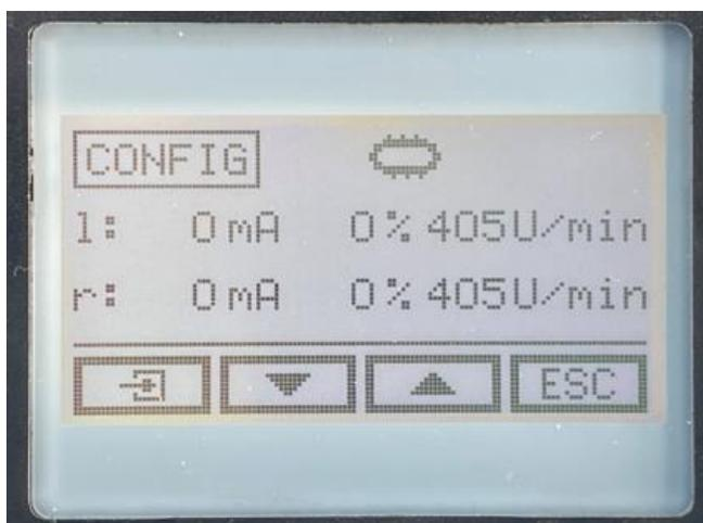
En cas de vitesses différentes du tapis à gauche et à droite, il est possible de corriger le flux de courant de la vanne du tapis. (en cas d'andainage latéral, le tapis de distribution tourne automatiquement un peu plus vite).
