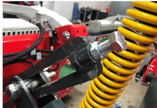
Réglage fin du support du relevage pour utilisation dans la paille (céréales, maïs).
