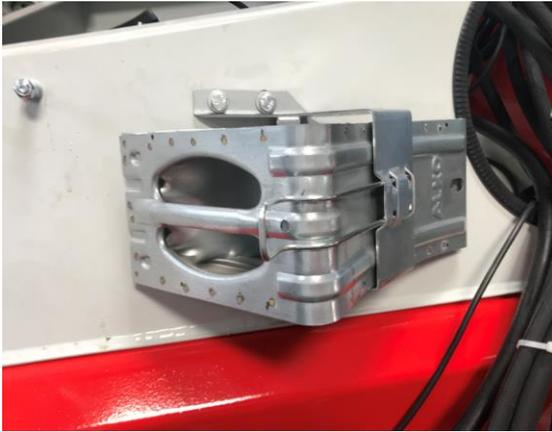
Cale de roue pour un stationnement sécurisé de la machine
