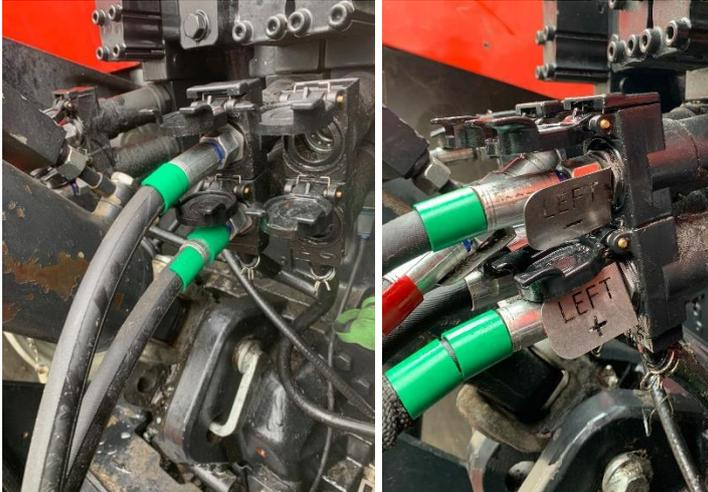
3. Connectez les flexibles double effet 2 au distributeur 2. Faites attention à la connexion correcte de la pression (RIGHT + / deux clips) et du côté retour (RIGHT - / un clip).
