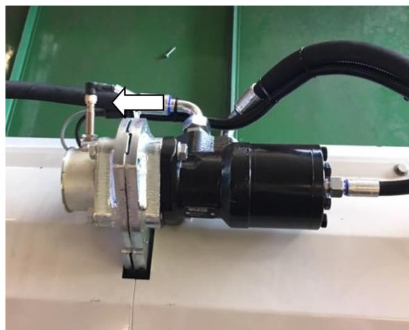
Capteur de vitesse de rotation du rotor
