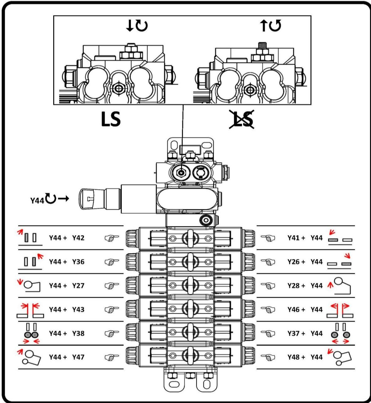
Für den Notbetrieb die Stellschraube Y44 ganz eindrehen. Schalten der jeweiligen hydraulischen Funktion durch Drücken der Notbedienung direkt am Ventil.
