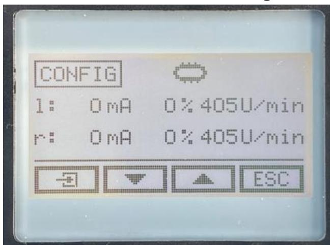
Bei unterschiedlichen Bandgeschwindigkeiten links und rechts kann die Bestromung vom Bandventil korrigiert werden. (bei Seitenschwadablage läuft das abgebende Band automatisch etwas schneller).
