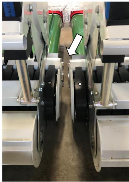
Traktorhubwerk so einstellen, dass die Gelenkwelle horizontal ist. Arbeitseinheiten auf ebenem Boden absenken. Nun den Abstand zwischen den Pick-up's wie im Bild erkennbar kontrollieren. Die werksseitige Einstellung beträgt ca. 2-3 cm.
