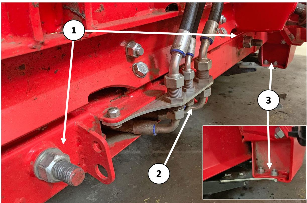
2. Die Hydraulikleitungen zum Antrieb der Pick-up ② markieren (Druckleitung / Rücklauf) und lösen. Austritt von Hydrauliköl durch Verwendung von Verschlussstopfen vermeiden.
