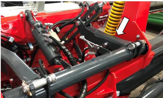
Die Querlenkerzylinder ziehen die Arbeitseinheiten nach dem Absetzen ganz nach innen
