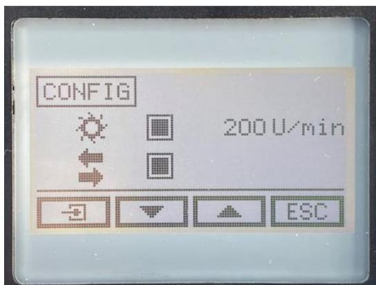
Die Maximale Pick-up Drehzahl ist einstellbar. Grundwert max. 200 U/min. Dies Reduziert die Gefahr vom Futtereinziehen.
