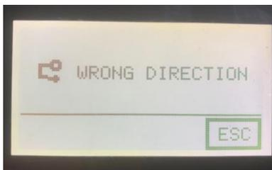
=> Arbeitseinheiten ganz anziehen bzw. Steuergeräte richtig betätigen!
