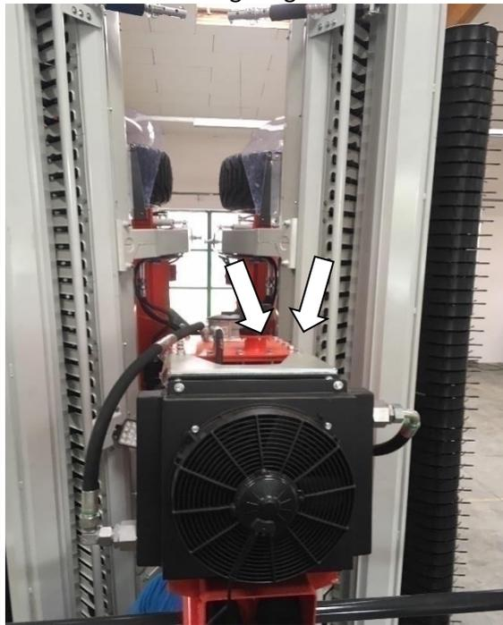
Rücklauffilter und Öleinfüllstutzen
