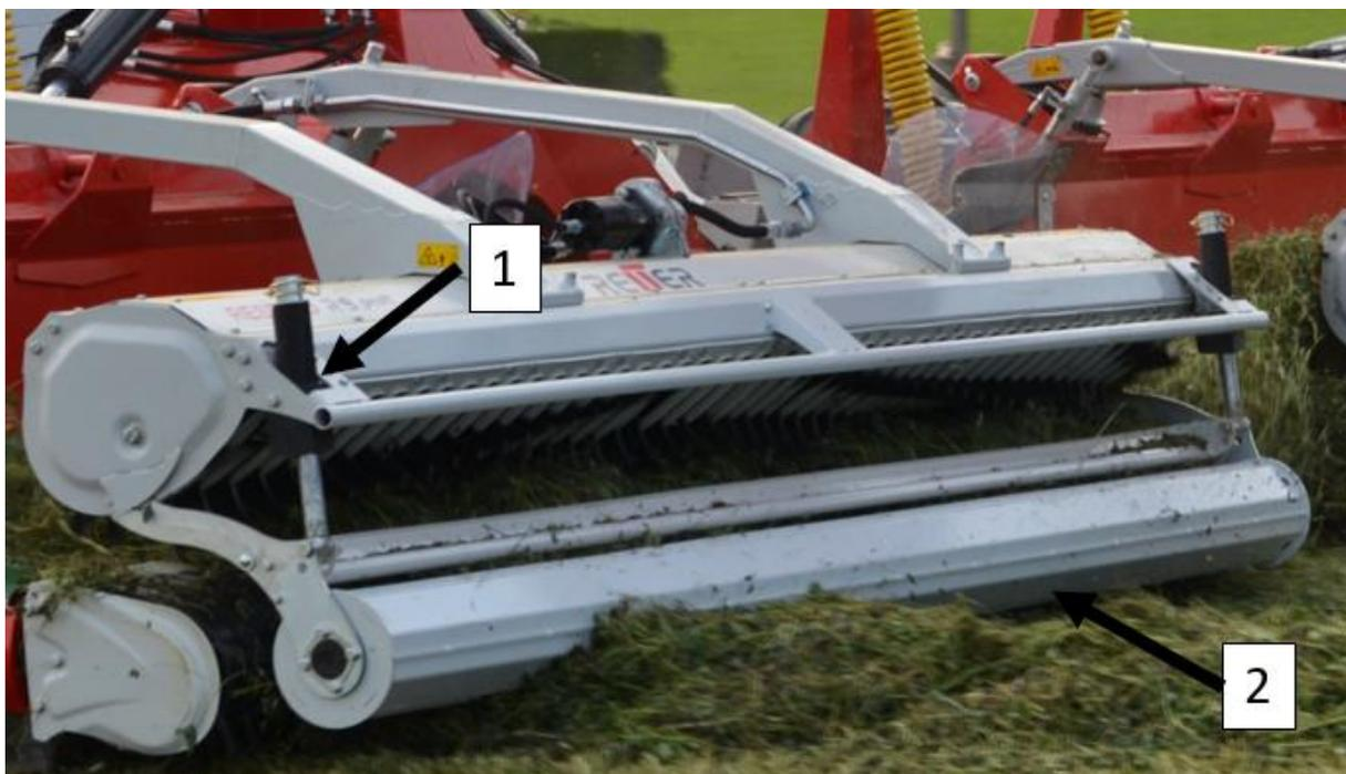
Aufhängung (1) Schwadrolle (2): federentlastet und in der Höhe verstellbar.
