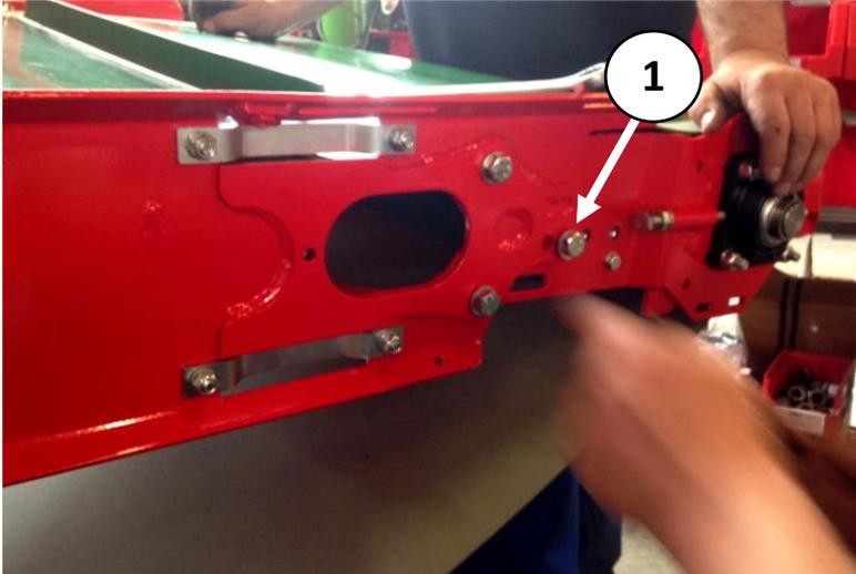
3. Förderband im nicht gespannten aber straffen Zustand: am Band eine 1000 mm Marke ② anbringen. Danach das Band über die Feinjustierung so weit spannen, dass die 1000 mm Marke 1006-1008 mm beträgt ③.
