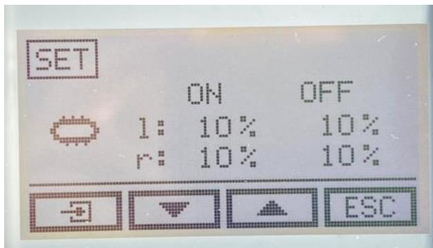
ON: Einstellung der prozentuellen Aushubhöhe am Hubwerk, ab dem das linke oder rechte Förderband beim Absenken im Vorgewende wieder eingeschaltet wird.
