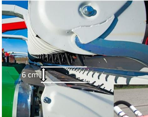
Höheneinstellung des Rotors (Abstand Rotor zu Pick-up)
