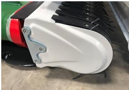
Verstärkungsblech Pick-up Deckel innen dient zum Schutz der Schrauben und des Seitendeckels für den Fall, dass sich die Pick-up's touchieren.
