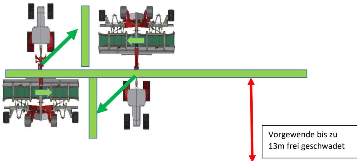
12. Zur Feldreinigung gegebenenfalls nach dem Häckseln, oder an Stellen wo Futter liegengelassen ist, die Bänder abstellen und die Reste am Band ansammeln. Danach kann diese Restmenge am Feldrand entsorgt werden oder zu bereits gelegten Schwaden gelegt werden.
