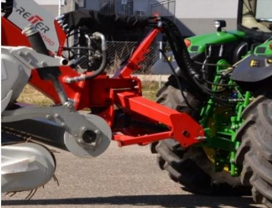
2. Steuergeräte 1 und 2 auf Druck geben bis beide Arbeitseinheiten zum Teleskoprahmen hin ganz angezogen sind.
