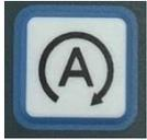
Bei gedrückt-halten dieser Taste werden beide Oberlenker-Zylinder komplett eingefahren
