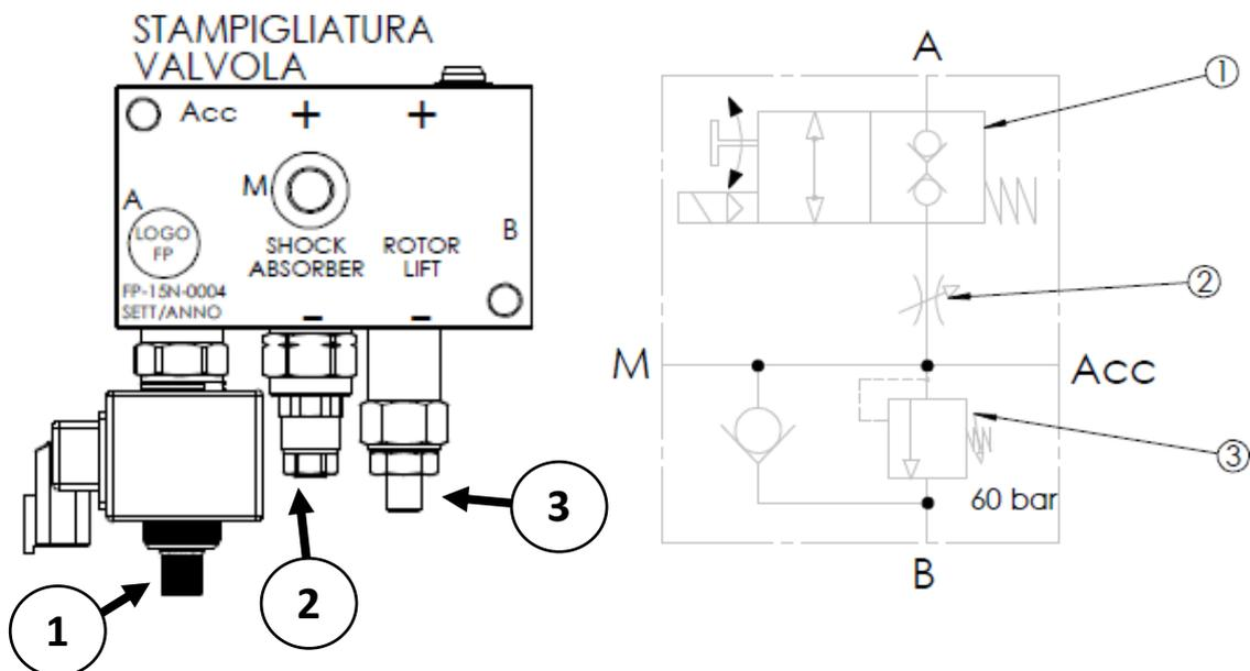
Normalbetrieb: Rändelschraube ① ist hineingedreht; das elektromagnetische Ventil kann auf Durchzug schalten oder absperren.
