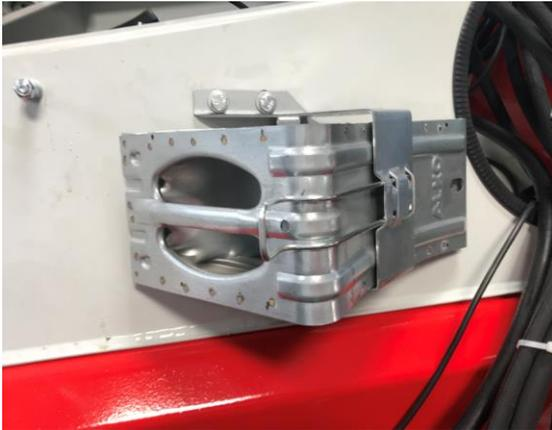
Unterlegkeil für das sichere Abstellen der Maschine
