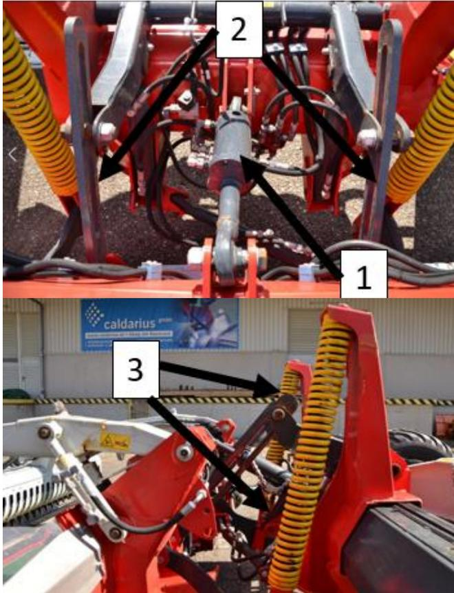
Über einen Oberlenker (1) und zwei Hubwerksstreben (2) wird eine Einheit an den Rahmen fixiert. Die Federentlastung der Einheiten erfolgt über die gelben Federn (3)
