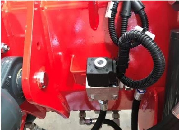
Elektromagnetisches Ventil zum Sperren der
