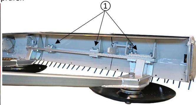
5. Verschraubungen an der Pick-up Wirbelsäule ① auf festen Sitz überprüfen (49 Nm Anzugsmoment / Feingewindeschrauben 60 Nm Anzugsmoment)
